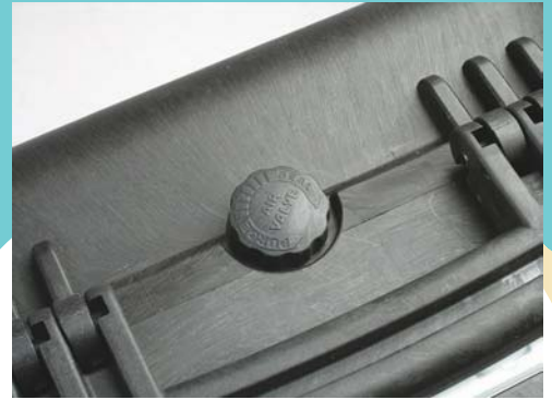
La valvola di depressurizzazione, presente in tutte le valigie realmente stagne: serve per equilibrare la pressione interna della valigia con quella esterna, per esempio dopo un volo.
